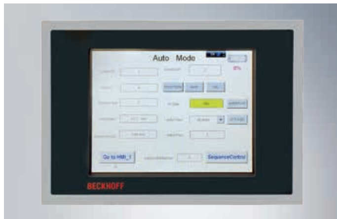
通过 TwinCAT 3 PLC 人机界面，操作人员可以在人性化界面中输入 AGV 参数并识别各种报警信息
