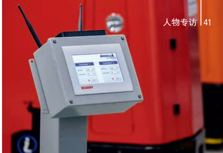
America in Motion 呼叫站点采用倍福的“经济型” CP6606 面板型 PC，操作人员可以使用它给 AGV 小车发送信号
