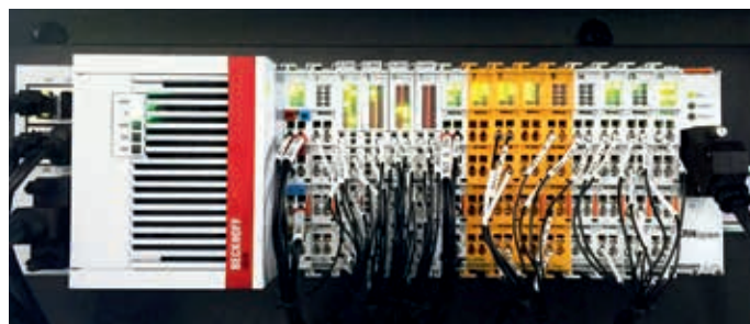
配有 EtherCAT 和 TwinSAFE 端子模块的 CX5130 嵌入式控制器为 AGV 系统提供了非常紧凑的控制解决方案
