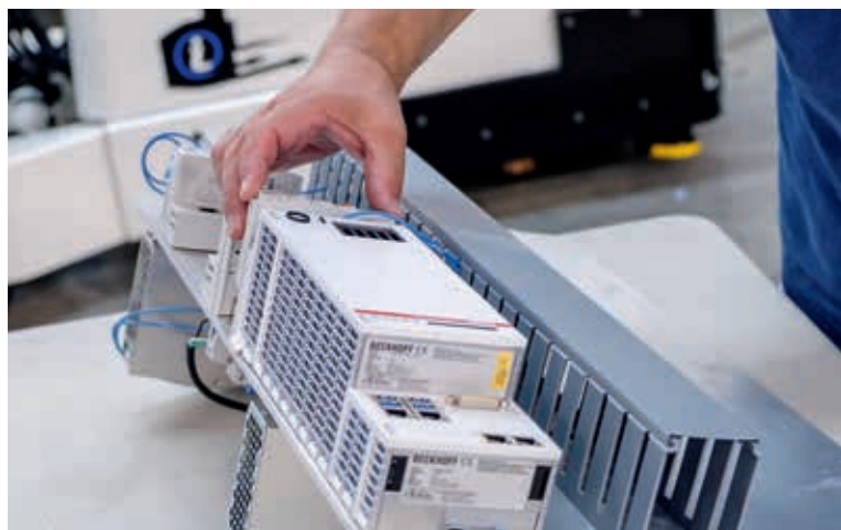
America in Motion 使用倍福的 CX2042 嵌入式控制器作为控制平台，使用 EtherCAT I/O 和 TwinCAT 3 实现先进的 AGV 小车功能
