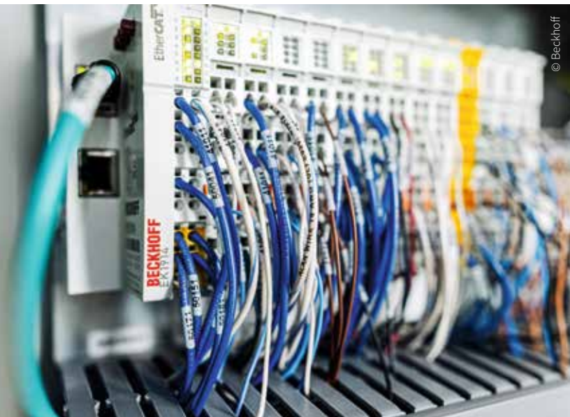
结构紧凑的 EtherCAT 端子模块和总线耦合器 (包括带 TwinSAFE 功能的 EK1914 耦合器) 将高速实时通信与功能安全完美结合于一体
