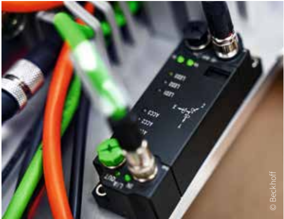
倍福的 EtherCAT 端子盒 EP3751-0260 结构紧凑,防护等级高达 IP67,可直接安装在机器设备上。该端子盒创新性地集加速度计与陀螺仪于一体,可实现高精度的追踪与运动控制
