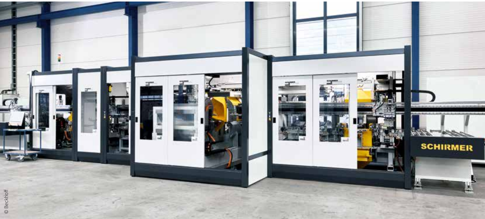
这台用于全自动加工 PVC 窗框型材、长达 14 米的 Schirmer 设备，首次采用 MX-System 替代了此前所需的所有控制柜
