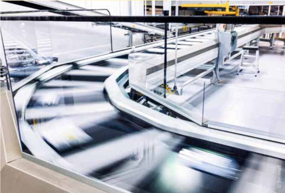
EuroSort 的单层落袋式托盘分拣机与贸泽电子现有的货到人系统无缝集成
