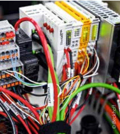
Enzo 配备了安全技术(黄色端子模块),并通过倍福的 ELM7222-9018 伺服电机 I/O 模块(右)实现精准的运动控制。这些模块结构极为紧凑,可轻松嵌入 AMR 机 身内部
