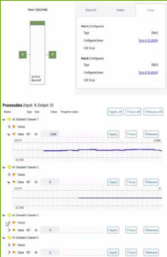
TwinCAT 中集成的示波器工具，可用于提供对 EtherCAT 网络性能和诊断数据更深入的洞察
