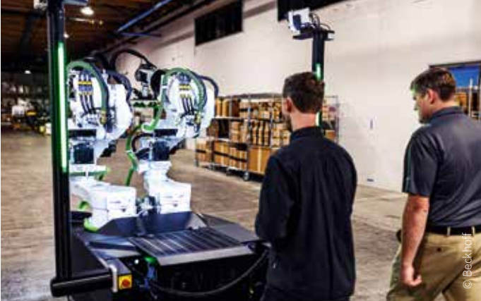
Mech 超紧凑的移动底座配备四个可转向轮,能够移动、旋转和爬坡
