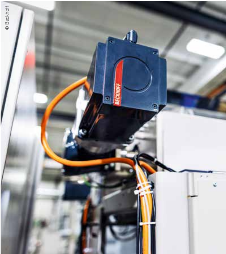
包括大型风冷电机在内的倍福 AM8000 伺服电机确保了连续和间歇运动轴的可靠运行
