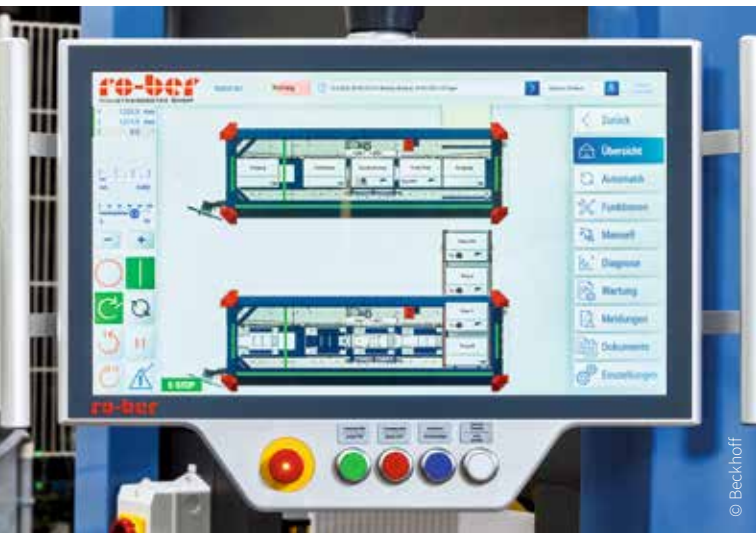
操作人员可通过定制的倍福控制面板访问联网系统的所有功能和过程数据
