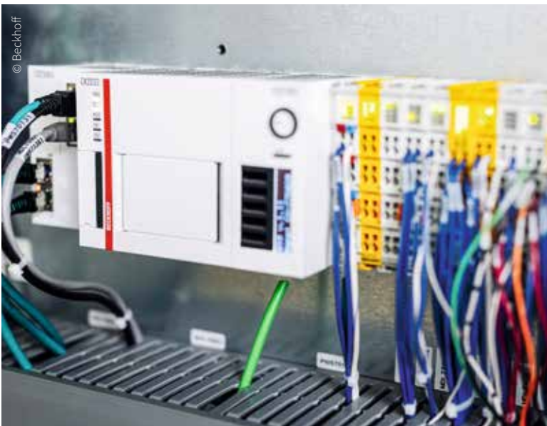
倍福的 CX2033 嵌入式控制器是 1400-GEC 快递袋包装机中配备的唯一设备控制器，显著提升了扫描速度
