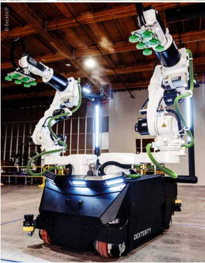
上图: Mech 超紧凑的移动底座配备四个可转向轮, 能够移动、旋转和爬坡
