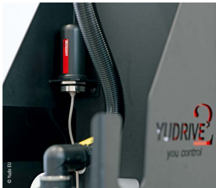
安装在防护等级为 IP66 的 CU8210-M001 机柜防护罩上的无线 U 盘可以方便地远程访问现场系统
