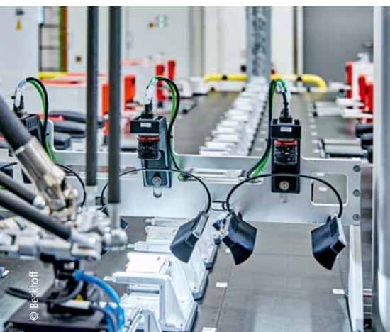
横立于三条通道上的视觉系统，会在每个端子模块通过时捕捉其 DataMatrix 码，然后将其与 XPlanar 动子的 ID 联系起来
