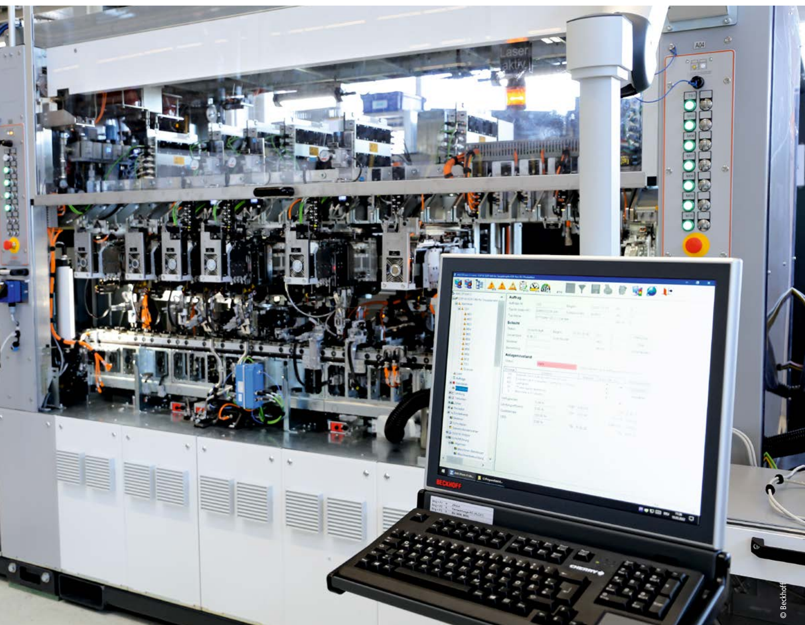
LTM-CI 线性输送系统是 STIWA 目前推出的一款复杂程度较高的装配系统
