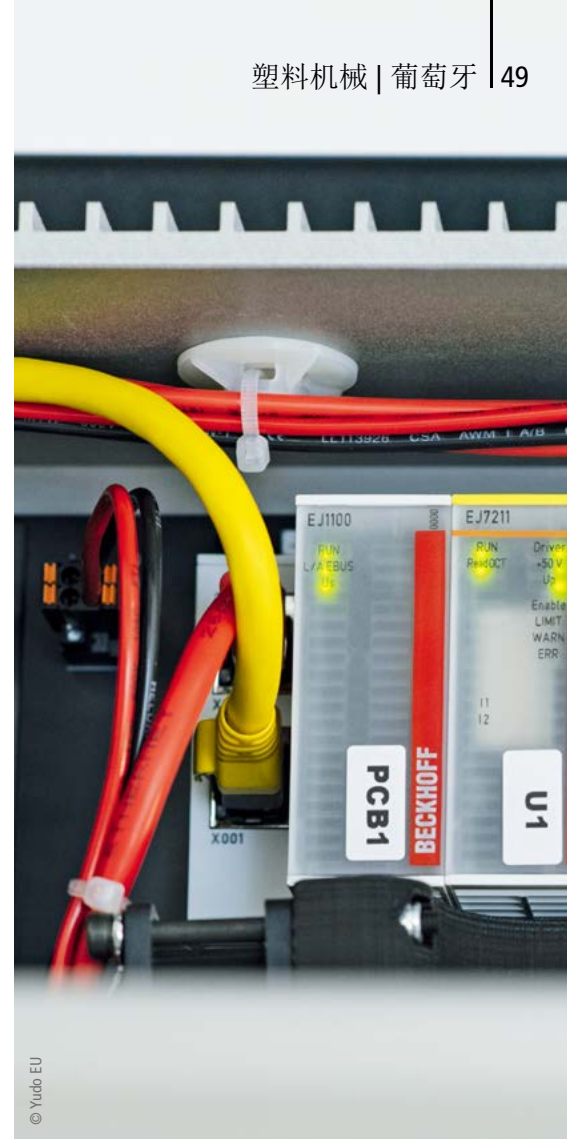
EJ 系列 EtherCAT 插拔式模块可以让 I/O 层的设计变得非常紧凑
