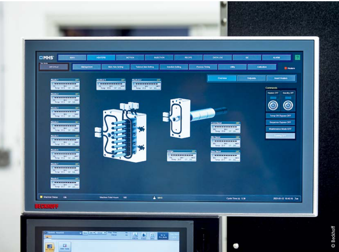
MHS 选择了倍福的 21.5 英寸 CP3921 多点触控控制面板，为操作人员提供了更大的透明度和可用性
