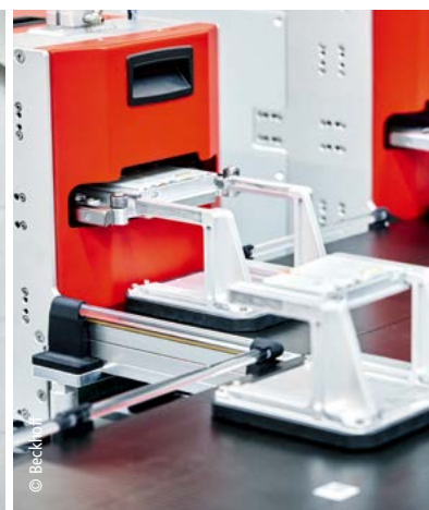
AA3000 电动缸用于载入端子模块载具体；AA1000 性执行机构用于降低触点引脚
