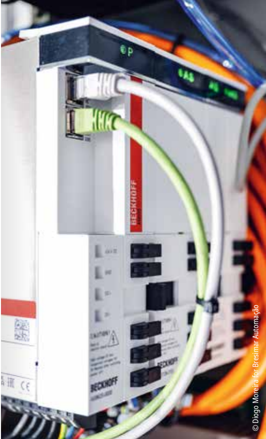
AX8000 多轴伺服系统通过硬件内置的电流控制器与位置控制器的 16 kHz 时钟频率, 实现了直角坐标机器人各个轴的高精度动态定位控制
