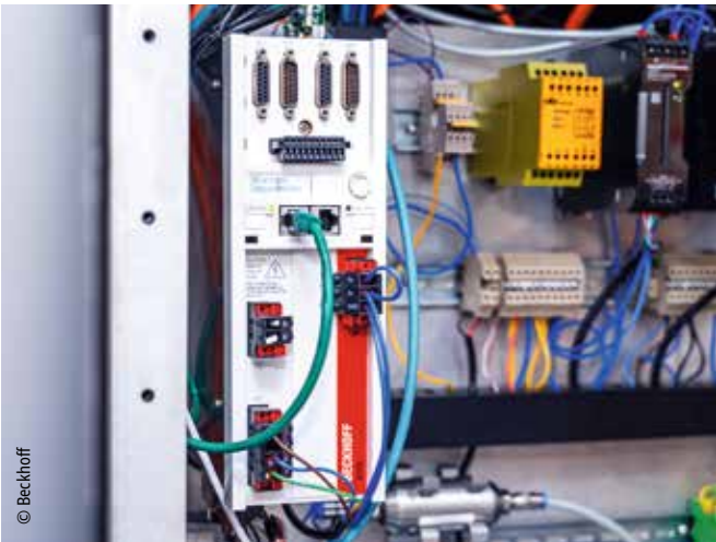
双通道 AX5206 伺服驱动器确保实现高精度、高动态的运动控制
