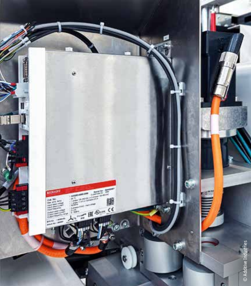
3D 打印需要精确的运动序列，Additive Industries 公司通过 AX5000 伺服驱动器与 AM8000 伺服电机实现这一需求
