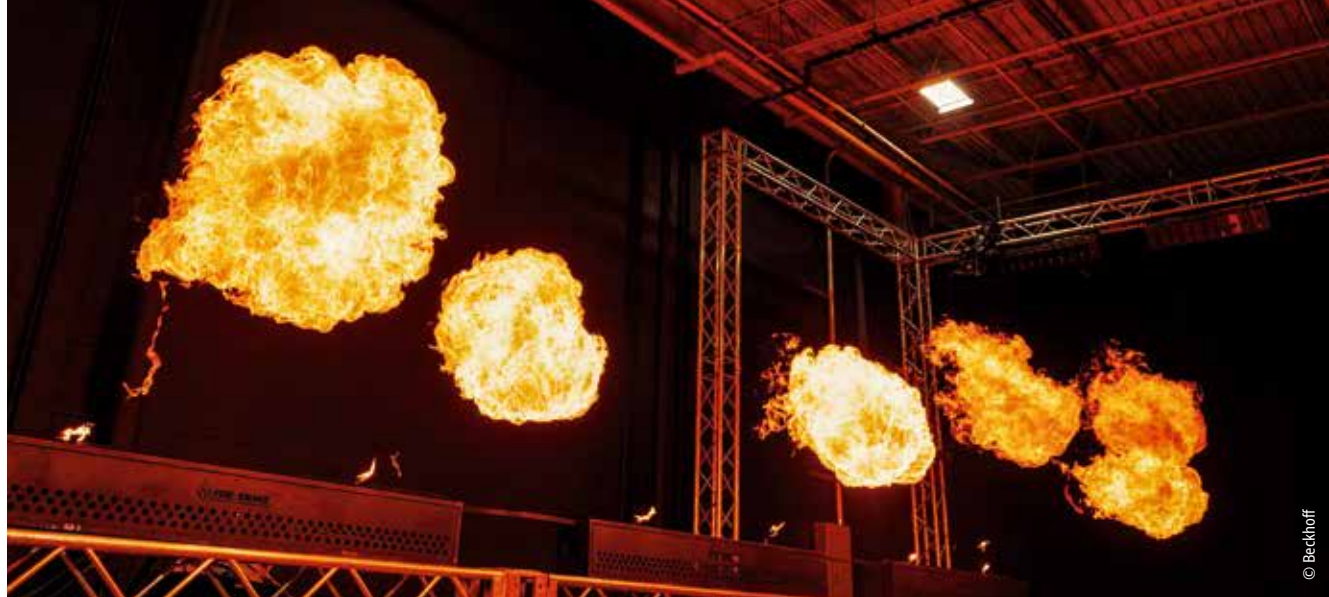
丙烷燃烧器既能产生持续火焰,火焰高度可调节,最高可达 1.80 米,还能借助爆破阀制造出翻滚的火球
