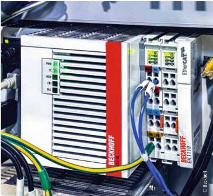
CX5140 嵌入式控制器构成注塑机的高性能控制核心
