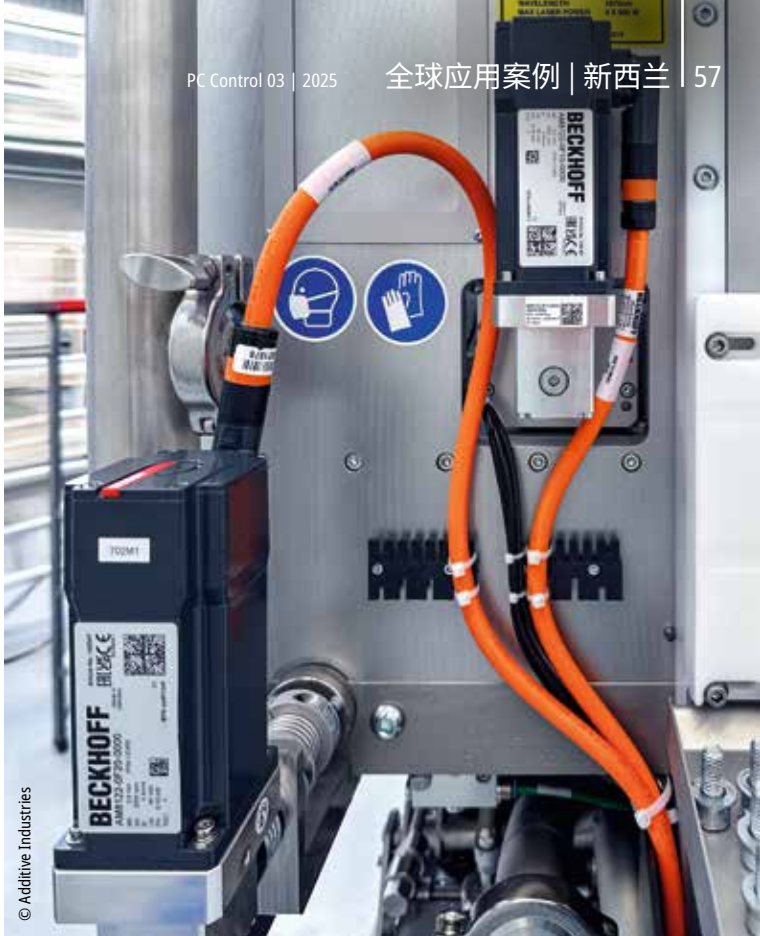
3D 打印机的轴数量最多可达 14 个，这些轴由 AM8000 伺服电机进行精确且高动态的运动控制
