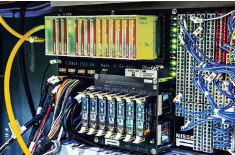
安装在客户定制信号分配板上的 EJ 系列 EtherCAT 插拔式模块 能够实现高度紧凑、标准化且灵活的 I/O 层
