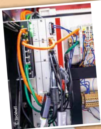
搭载 TwinCAT 软件的 C6930 控制柜式工业 PC 构成生产系统的高 性能控制核心
