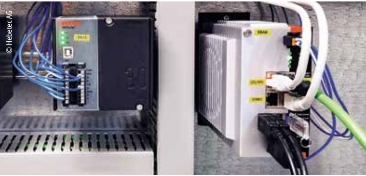
TwinCAT 软件与 C6030 超紧凑型工业 PC 协同控制多台千斤顶，实现对隧道管节的精确调平、匀速加压和精准对齐
