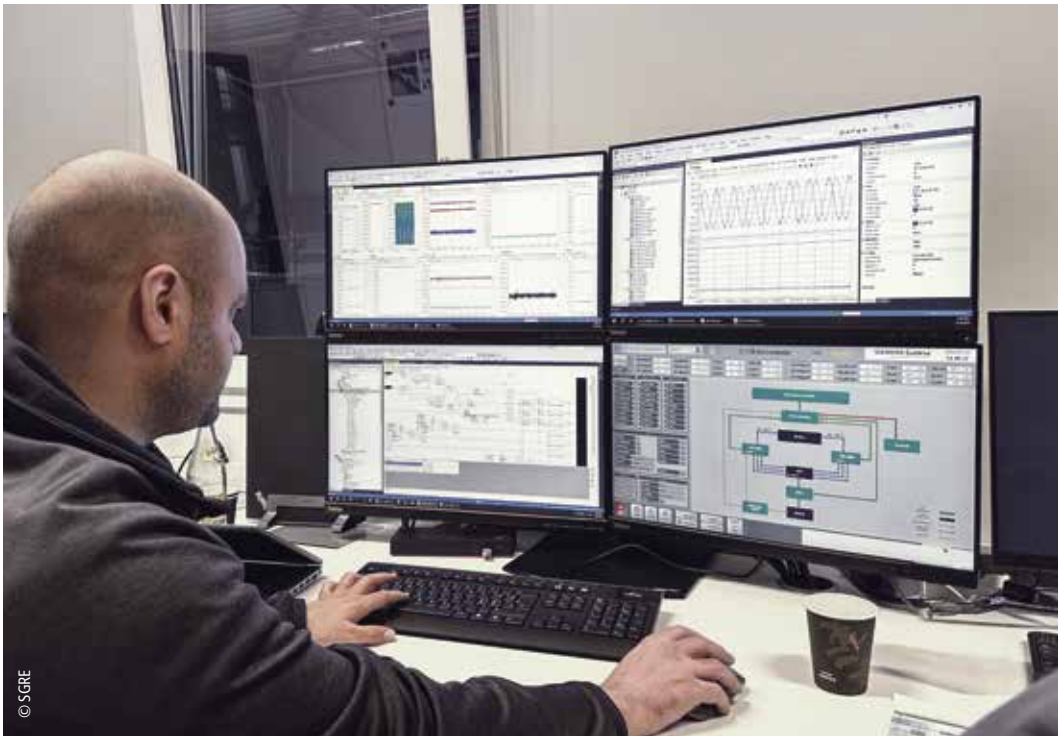
倍福 TwinCAT 软件在西门子歌美飒试验台中发挥关键作用：TwinCAT 3 Scope View 用于数据分析（上方两个屏幕），TwinCAT 3 Target for Embedded Coder®（左下），以及 TwinCAT 3 HMI（右下）提供便捷的系统操作界面
