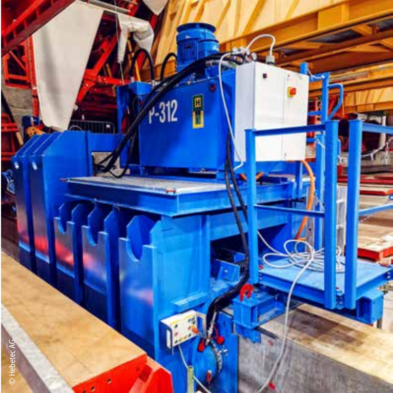
在连续生产过程中，六台配备双油缸的顶推装置将隧道管节平稳推送数百米，使其通过狭窄的闸门进入干船坞
