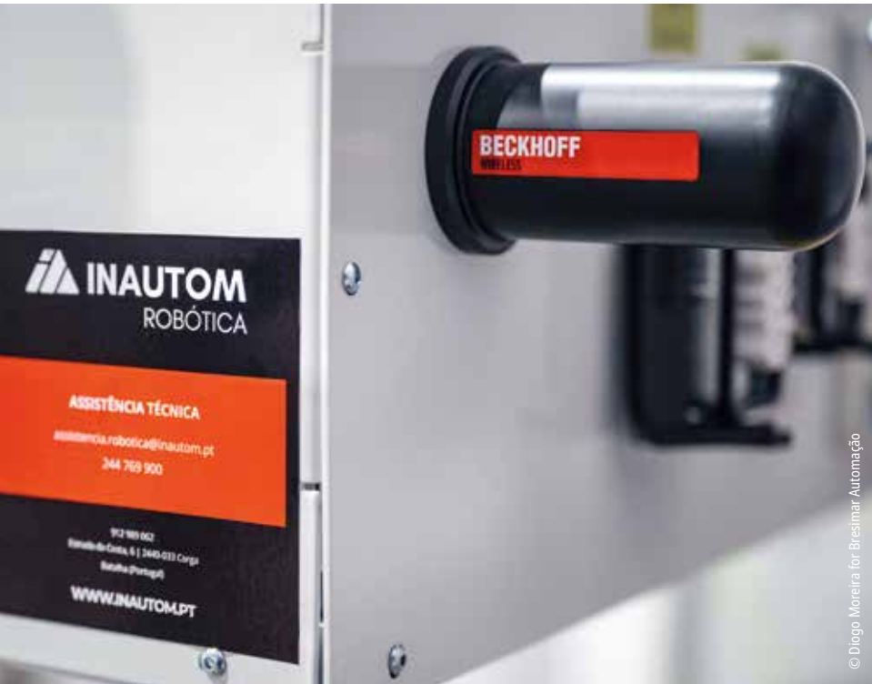
为满足机器人无线通信要求, INAUTOM Robótica 采用了倍福 CU8210-M001 机柜防护罩, 用于保护工业 WLAN 和移动通信组件
