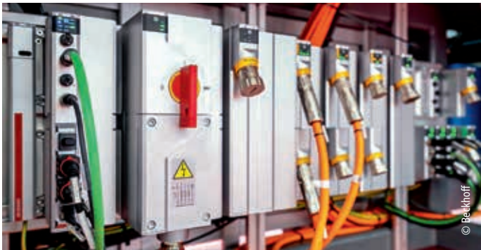
将 MX-System 集成在绕线机底座结构内，可完全省去传统控制柜
