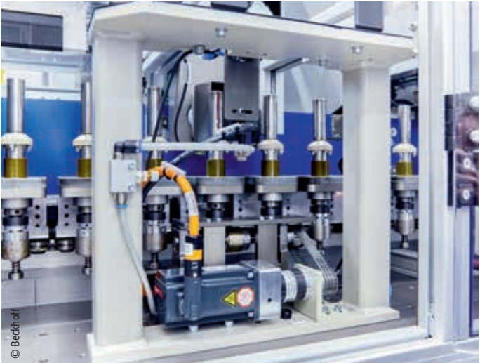
在总计 13 个工站上,通过与 AM8000 伺服电机相连的磁藕,可带动电芯旋转,以此实现如从各个侧面进行检测这类作业
