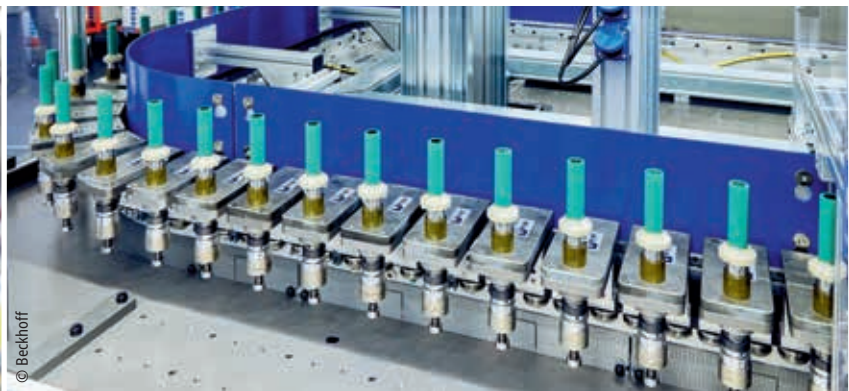
两个镜像对称的子系统尺寸均为 15 米 x 3 米,各自搭载了一套循环轨道长度为 28.5 米的 XTS 系统(图中所示为加热风洞后的缓冲区)
