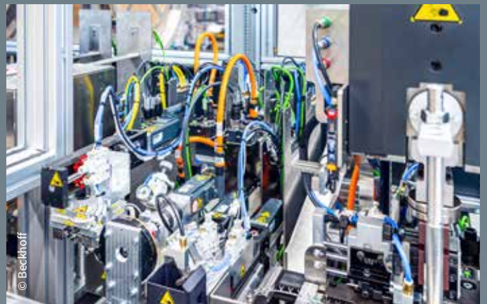
Lambda X 采用了倍福的紧凑型驱动技术，使用 EP7211 EtherCAT 端子盒驱动 AM8100 伺服电机
