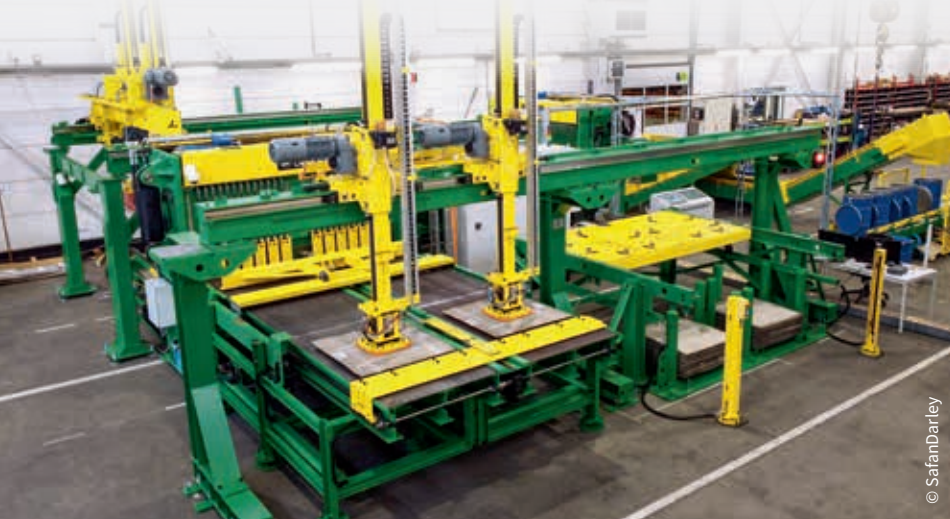
镍切割线概览：前端为镍阴极板的输入位置，最右侧为切割后镍块输出至料桶的位置
