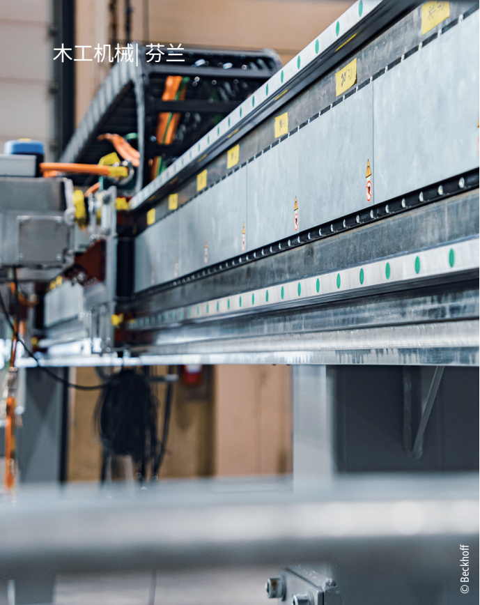
高动态的 AL8000 直线电机确保了系统的高动态性能和高精度
