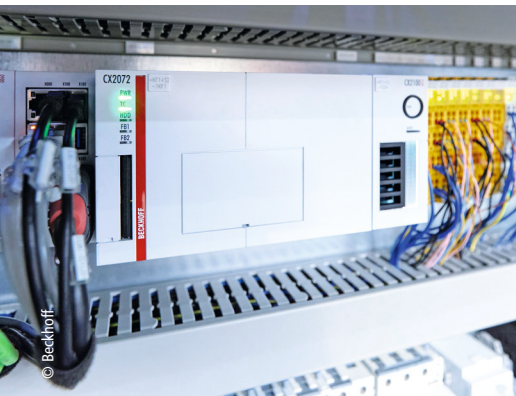
CX2072 嵌入式控制器与直接连接的 EtherCAT 和 TwinSAFE 端子模块用于控制所有运动和测试程序
