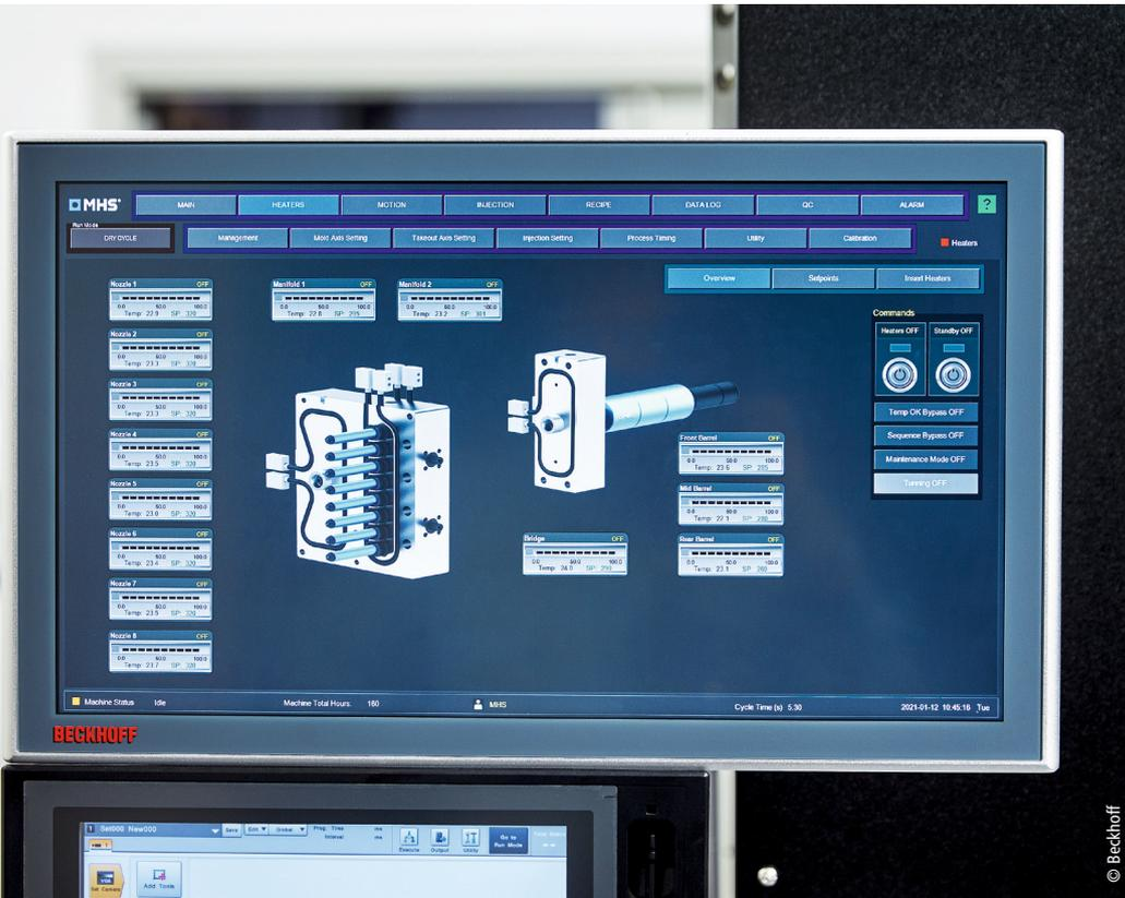
MHS 选择了倍福的 21.5 英寸 CP3921 多点触控控制面板，为操作人员提供了更大的透明度和可用性
