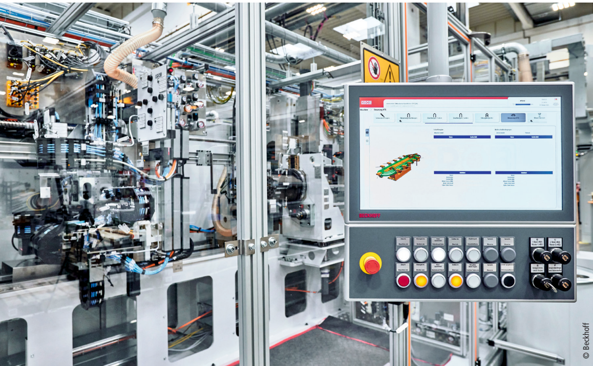
CP3918 多点触控控制面板，加上专用的按钮扩展件和用 TwinCAT HMI 创建的简单易用的用户界面，可以优化使用所有设备功能
