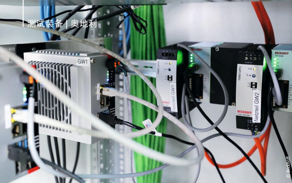
通过倍福 PS 系列电源产品（右）供电的 C6030 超紧凑型工业 PC（左）用作边缘计算网关，起着核心作用
