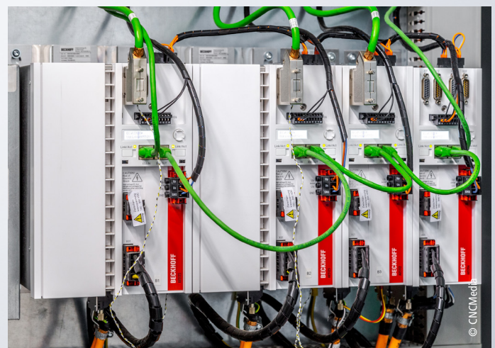
AX5000 伺服驱动器确保激光头高动态和高精度的轴运动
