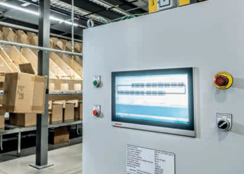
EuroSort 落袋式分拣机采用倍福的 CP29xx 系列多点触控控制面板作为人机界面
