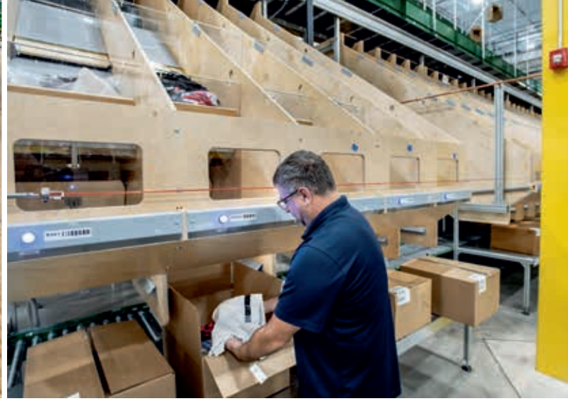
EuroSort 的落袋式分拣机为塑料袋装物品和非塑料袋装物品提供业内最紧凑的分拣解决方案，确保在提高吞吐量的同时容纳更多的分拣下料口，减少设备占地面积
