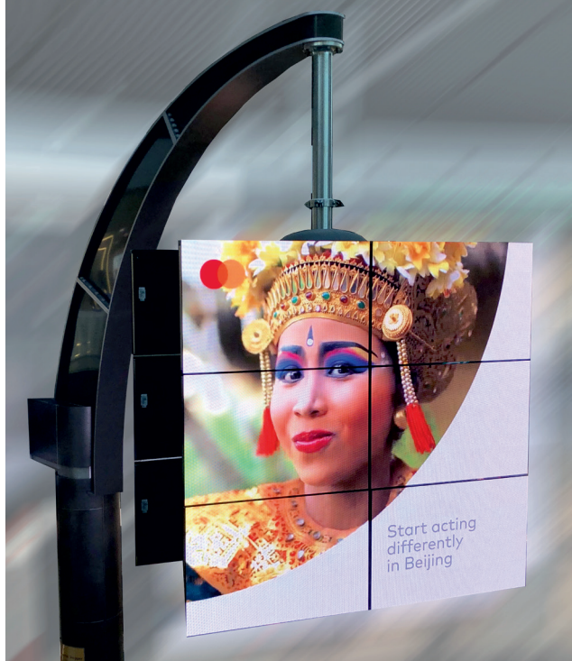
液晶显示屏可以动态组合和再次分离，可以悄无声息地排列成不同样式的队形，并可快速拼接成更大的或巨型屏幕（2/3/4/6 个显示屏）
