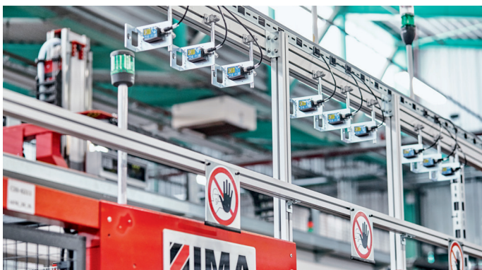
通过 TwinSAFE SC 端子模块采集来自总共 36 个传输时间传感器的模拟量信号
