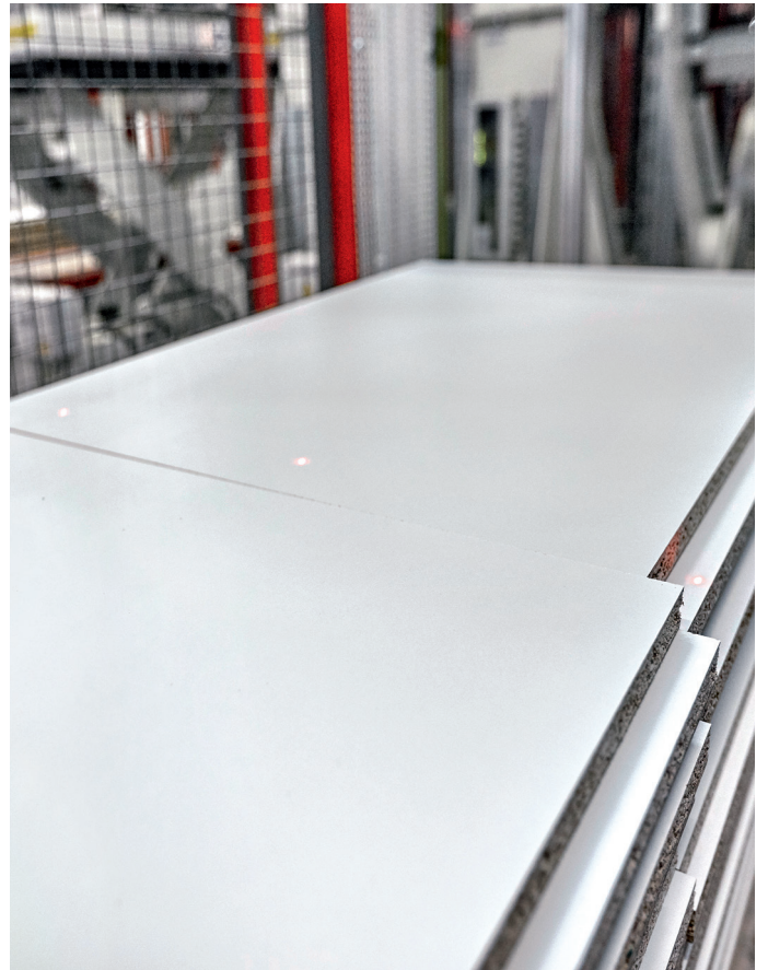
每个辊子输送机上有三个传输时间传感器（由三个光点显示）用来监测工件堆垛高度
