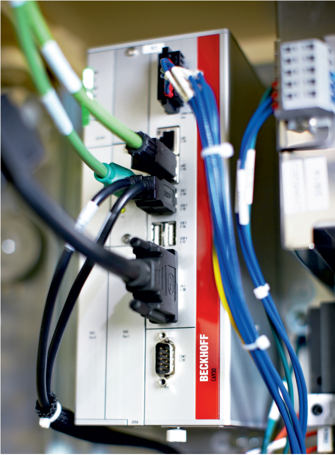
作为一个集中式多任务控制器，C6930 工业 PC 驱动整个 HyPET® HPP5 系统，包括 PLC、运动控制、测量技术、与辅助设备的通讯以及所有 HMI 功能
