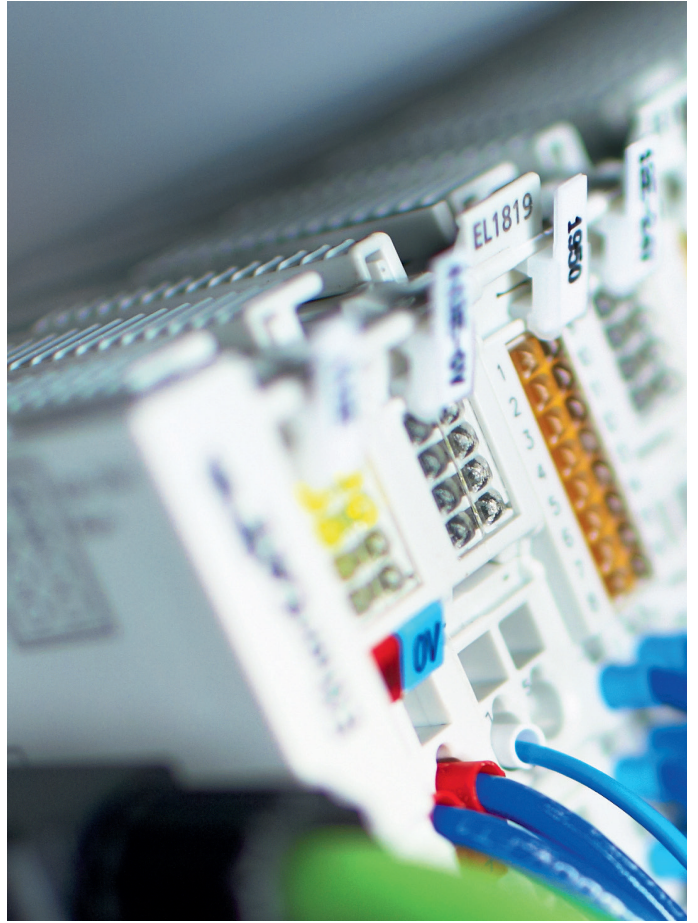
EtherCAT 端子模块系统也让赫斯基能够实施先进的 I/O 功能，如电力测量
