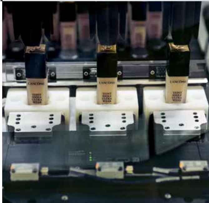
在灌装过程开始之前，搬运机器人会将空的容器装入卡盘（运输托盘）中，并根据每个产品的具体规格将卡盘固定在 XTS 动子上
