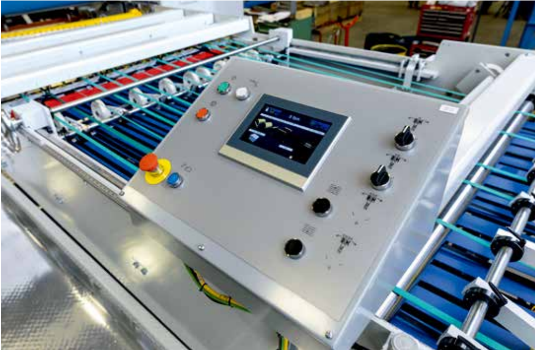
操作人员通过配备有 7 英尺高分辨率显示屏的 CP2907 多点触控控制面板控制对开切纸机
