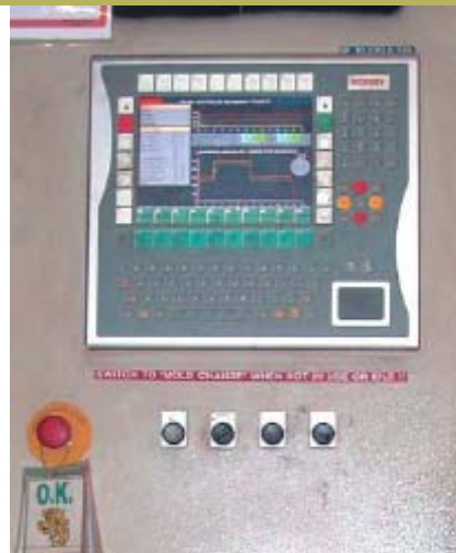
Beckhoff 的平板电脑 CP7130 作为压铸控制的核心。
