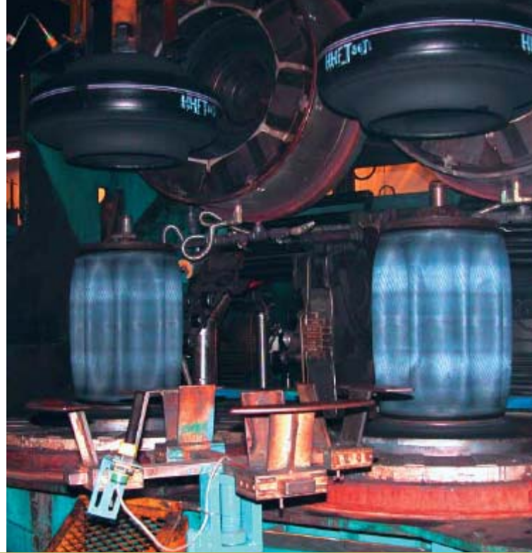
气囊膨胀使内部胎坯成型和缝接。
