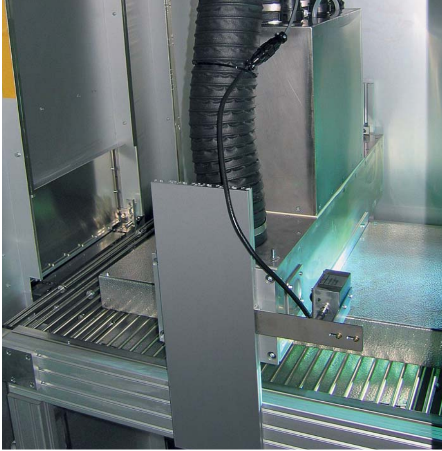
封装站中的塑料表面 通过上方的紫外线照 射固化
