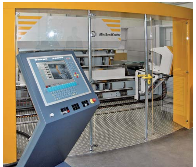
从该工业 PC 上分离出来的控制面板 可用作操作平台和可视化平台
