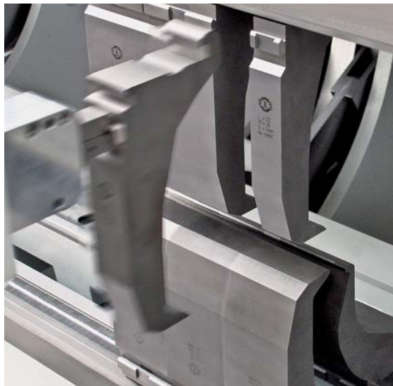
在开始折弯之前，换刀装置自动地为各个折弯工作站装上刀具。机器控制器从 CAM 系统上接收每个工作站所需的刀具长度数据
