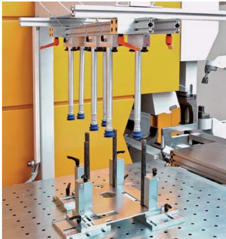
一个吸入系统把最上方的粗坯夹紧并带到输送台，输送台上有一个操控器，用于抓取零件，引导钣金件首先通过一个光学测量工作站
