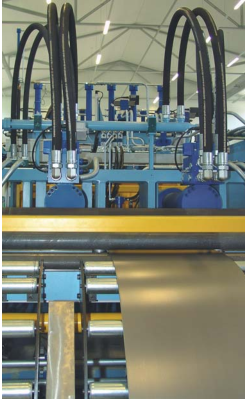
共有 12 根液压伺服轴生成 2 x 250 t 的液压推力，以折弯散热板
