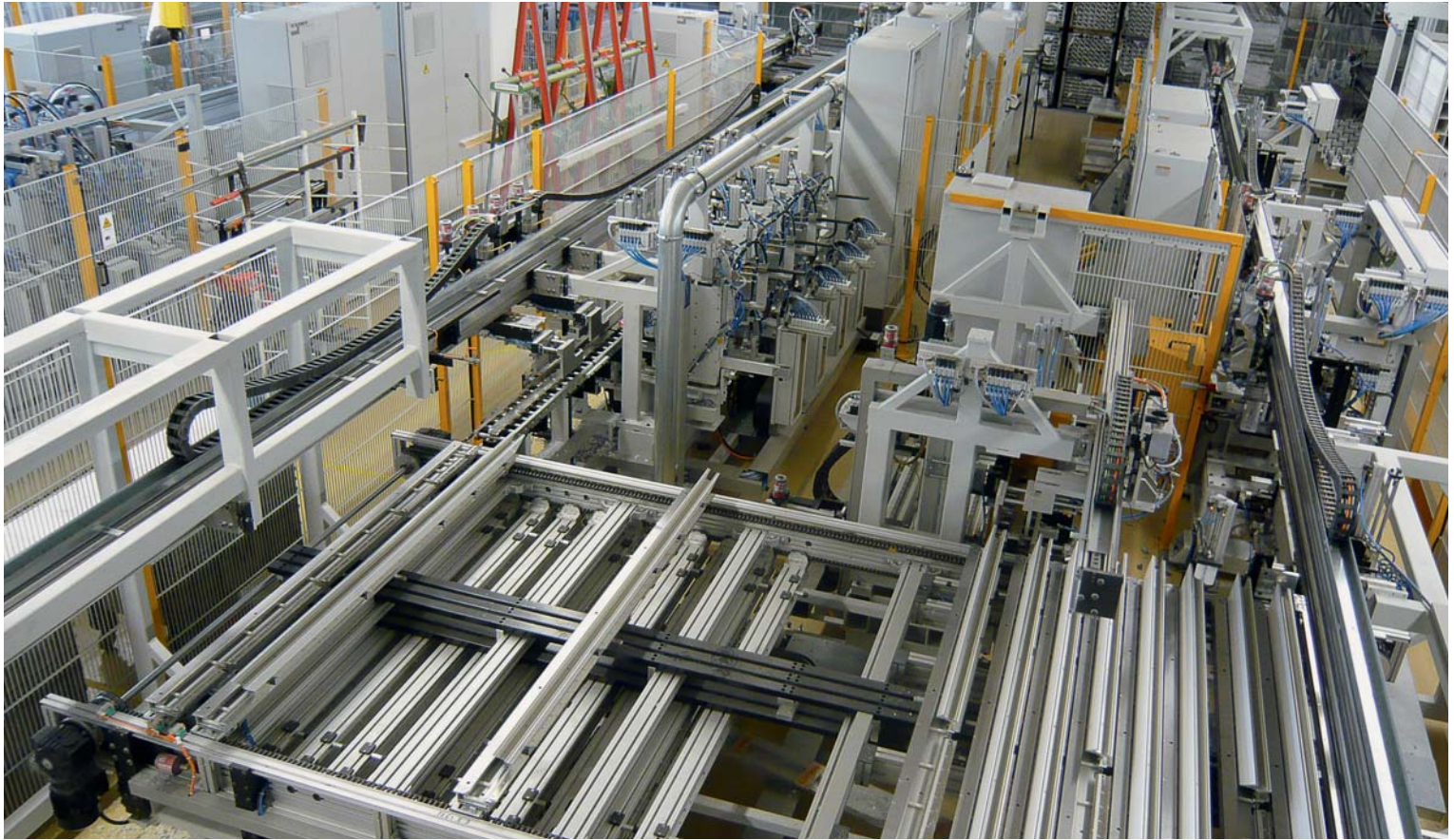
SBZ II 棒材加工中心，配备了一个适用于最长为 3750 mm PVC 型材的插入装置，以及定位速度高达 180 m/min 的 NC 定位夹持钳
