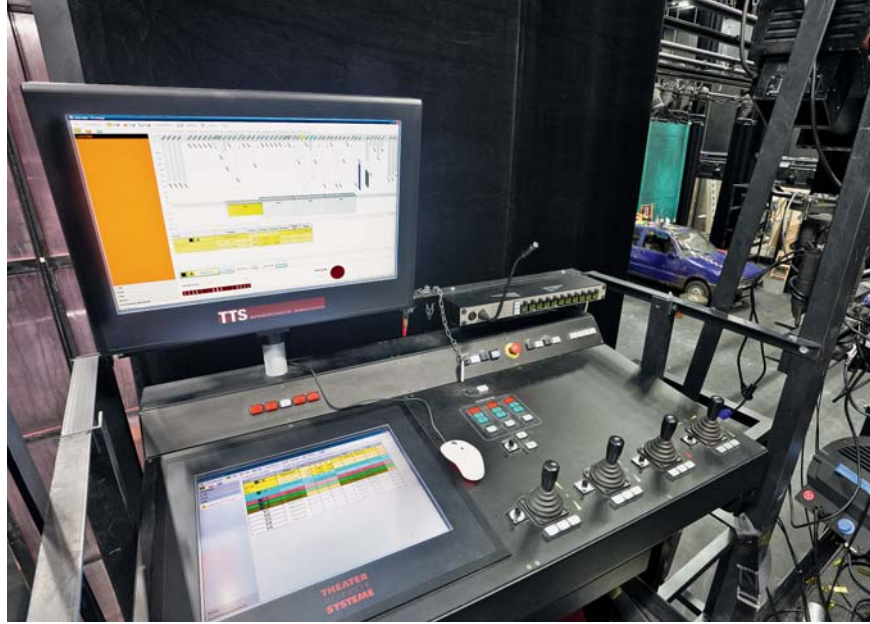
利用德国 TTS 专门开发的软件，可以实现舞台的可视化和可操作性。自 2002 年起，德国 TTS 公司便开始使用倍福公司的产品组件。“使用倍福公司的本地 I/O 产品，我们能够根据客户所需精确地量身设置系统。我们改用了倍福的面板型 PC 以及 TwinCAT 自动化软件之后，还成功地引入了总线端子” Frank Kremer 解释道，“最后，我们要选择一套适用的总线系统，最终我们选择了 EtherCAT，因为它包括了对我们来说最重要的功能：实时性，高带宽，线缆冗余式以及出色的诊断功能。”
