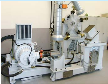
用于尾旋翼齿轮箱试验的试验台
