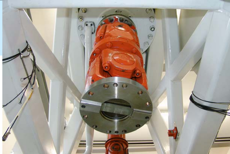
MGB 试验台上的电动机驱动装
