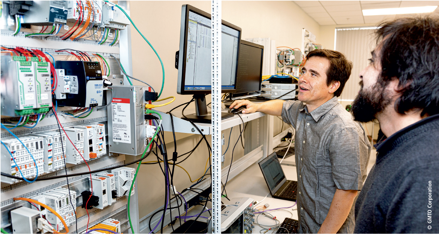
GMTO 工程师 José Soto（左）和 Hector Swett 正在使用倍福的 TwinCAT 3 自动化软件根据望远镜规格检验各个组件
