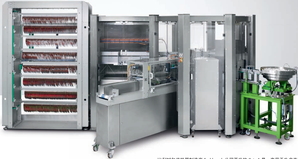
比利时包装机器制造商 Scaldopack 公司开发的 Octo-1 是一套用于生产直立袋的系统
