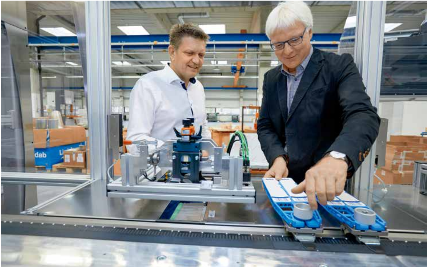
Koch Pac-Systeme 公司 Jürgen Welker (右) 向倍福的 Frank Würthner 展示如何轻松地切断泡罩托架快速实现产品切换
