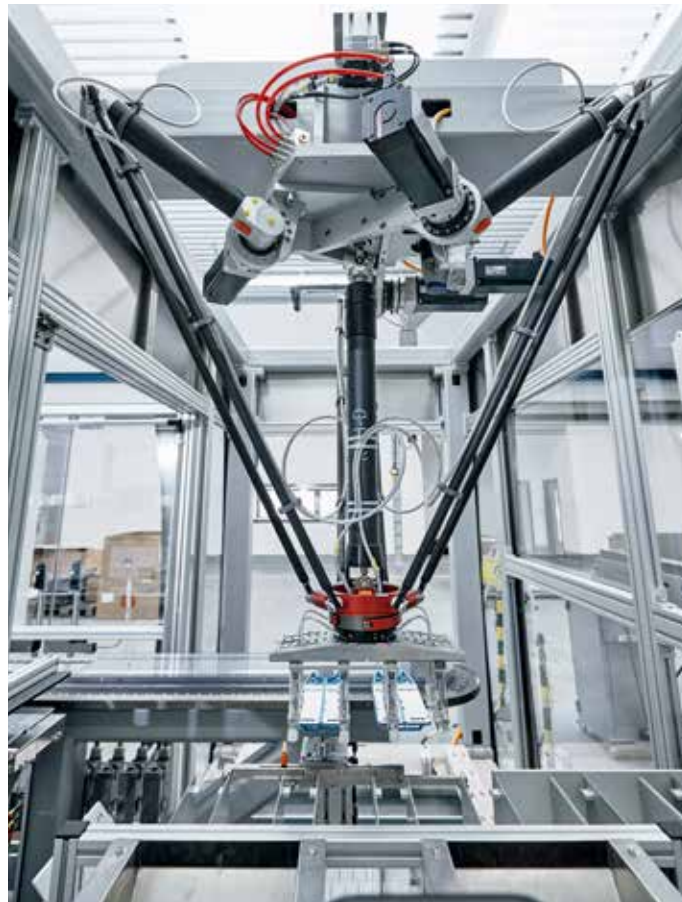
贴标和分组单元开始及结束处的两套高速拾放系统采用倍福的高动态伺服技术，通过一台 C6930 控制柜式 PC 与 XTS 一起控制
