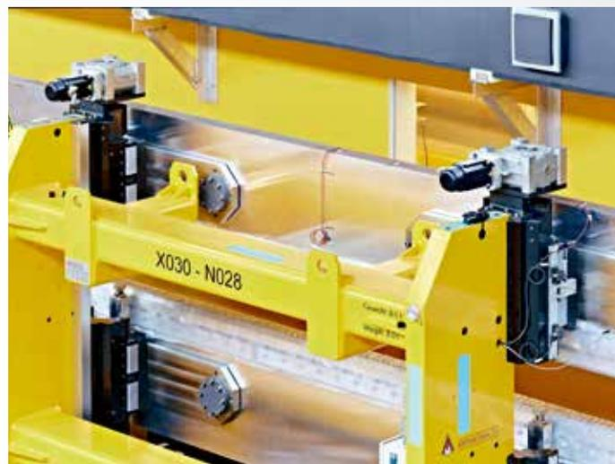
每个波荡器单元共有 4 个 AM3052 伺服电机 — 通过 TwinCAT NC PTP 控制 — 确保磁铁结构精确定位 (图片显示的是上面磁铁结构的两个电机)
