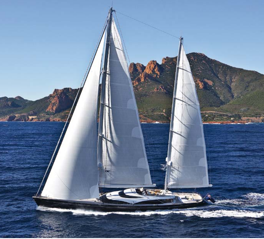
高科技游艇 Twizzle 在公海上第一次扬帆启航。这艘双桅游艇总长为 57.49 米，有三层甲板。Beckhoff 嵌入式控制器和总线端子模块共控制 3500 个传感器和执行器
